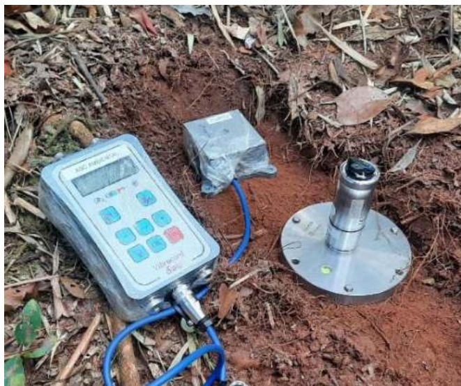
Equipamentos utilizados para medição de vibrações no terreno. Fonte: ASC Ambiental, 2021.
