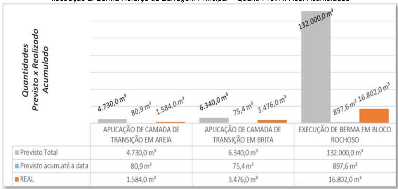
Ilustração 2: Berma Reforço da Barragem Principal – Quant. Prev. x Real Acumuladas
