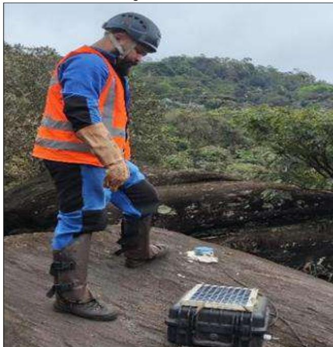
O Monitoramento Sismográfico vem sendo executado pela empresa BioEspeleo Consultoria Ambiental, em parceria com a SismoGeo Engenharia, nas cavidades BG-01, BG-05, LOC-0149 e SM-121 definidas em condicionante, pela SEMAD, para o projeto da Descaracterização de Germano. A metodologia de execução do monitoramento é a que foi descrita no âmbito da LOC nº 020/2019 (Parecer Único nº0603993/2019, PA COPAM 00015/1984/107/2017).
