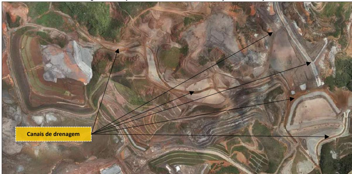
No caso da Cava do Germano as obras de reconformação do reservatório foram concluídas. A berma de reforço está em fase final de conclusão, conforme planejamento. O Canal de drenagem superficial localizado na ombreira direita está implantado em quase sua totalidade, restando a conclusão da região da bacia de dissipação inferior a montante do bueiro sob a rodovia.
