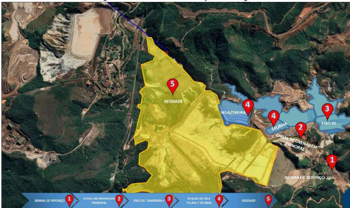
Na região do pé da barragem do Germano onde foi executada a berma de reforço e a implantação do canal de drenagem superficial da ombreira esquerda foram executadas obras de limpeza e de tratamento da fundação, bem como a implantação da drenagem passiva.
