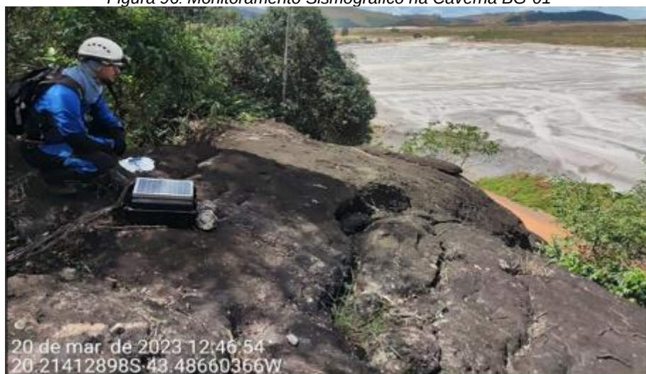
Figura 96: Monitoramento Sismográfico na Caverna BG-01
