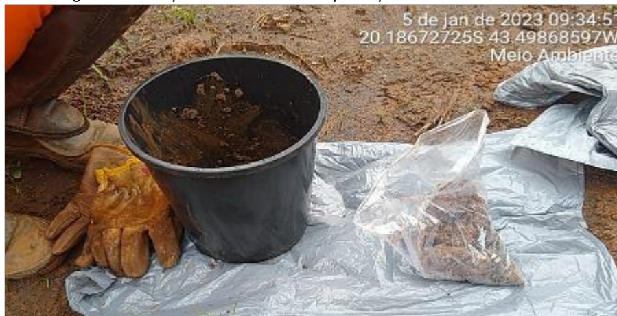
Figura 131: Preparo da Amostra Composta para Envio ao Laboratório
