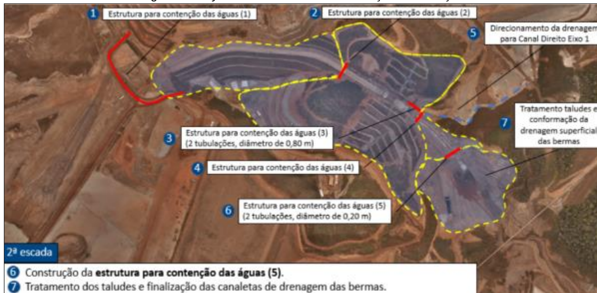
Figura 15: Layout das Estruturas de Contenção de Proteção
