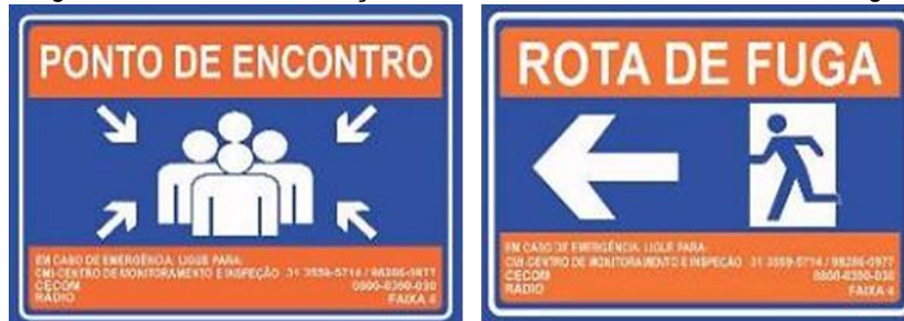
Figura 85: Placa de Sinalização de Ponto de Encontro e de Rotas de Fuga
