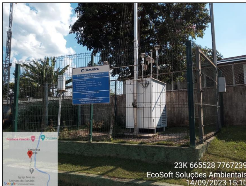
Figura 148: Vista da Estação de Monitoramento em Santa Rita Durão
