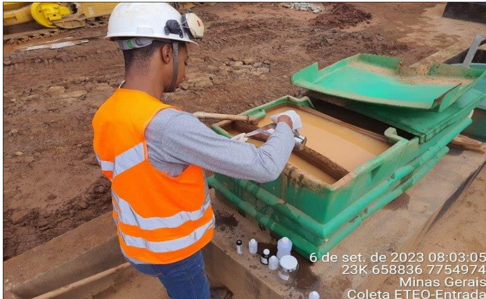
Figura 25: Análise de Efluente – Caixa SAO da Oficina de Manutenção da Empresa ‘MRF’
