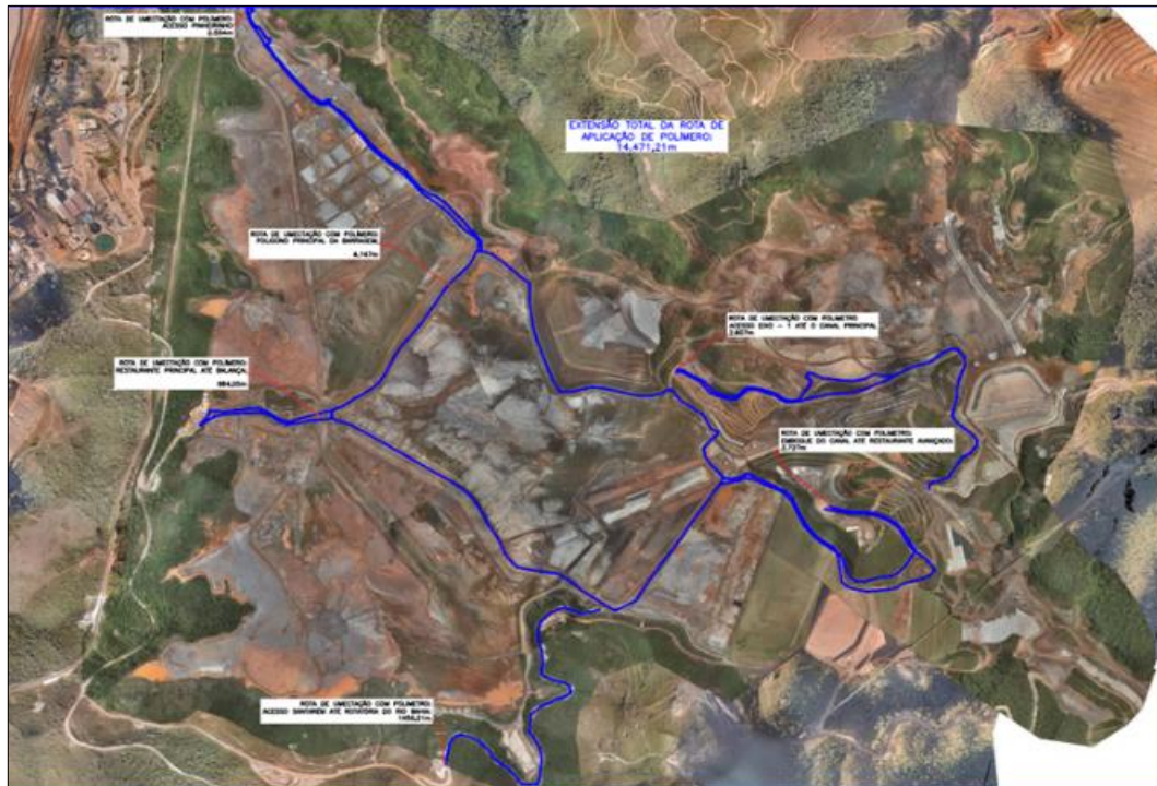
Figura 157: Rotograma de Umectação de Vias de Acesso com Aplicação de Polímero
