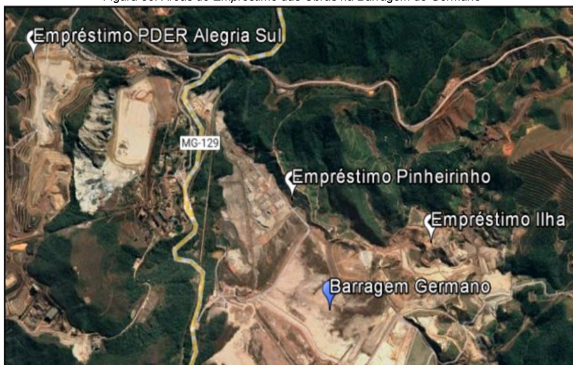
Figura 35: Áreas de Empréstimo das Obras na Barragem do Germano
