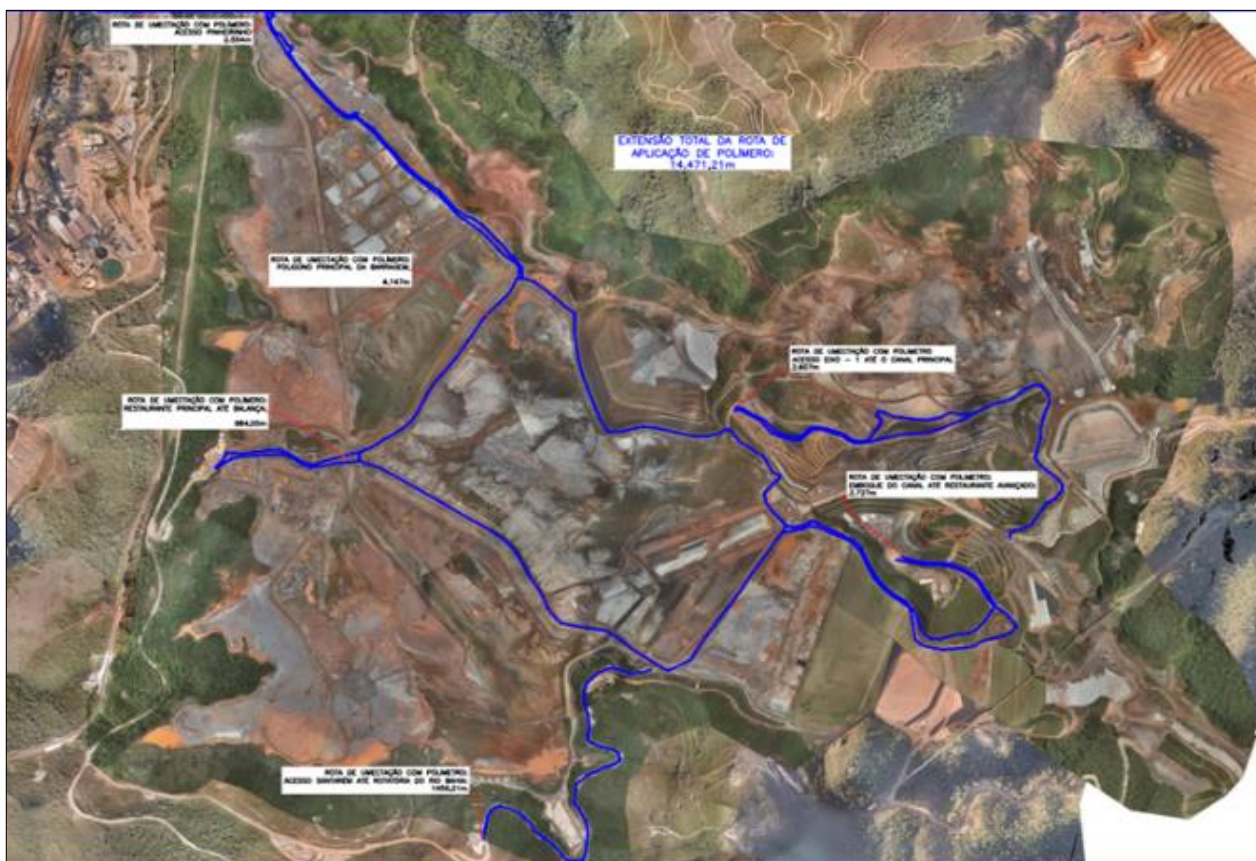
Figura 160: Rotograma de Umectação de Vias de Acesso com Aplicação de Polímero
