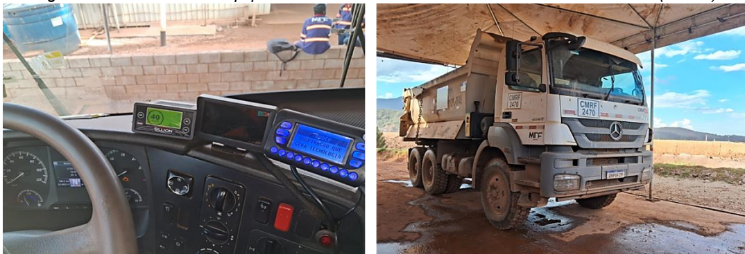
Figura 103: Veículo com Equipamento de Monitoramento de Velocidade – PCRC 01 (CMRF)
