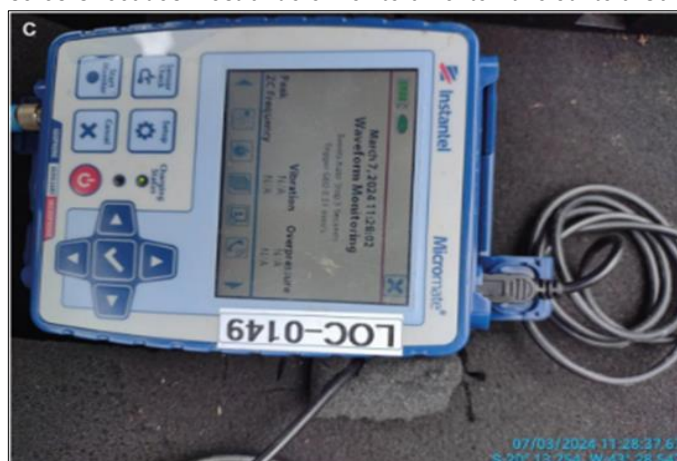
Figura 135: Sensores Checados Mostrando o Monitoramento Ativo Junto à Caverna LOC-0149
